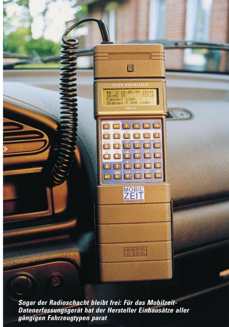
*Sogar der Radioschalt bleibt frei: Für das Mobilzeit-Datenerfassungsgerät hat der Hersteller Einbausätze aller gängigen Fahrzeugtypen parat*
