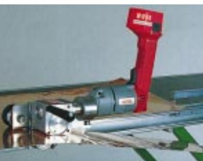
Aluminium, Kupfer und Zink 1,2 mm bei 14 m/min. Die Nennleistungsaufnahme beträgt bei beiden Maschinen 500 W.
