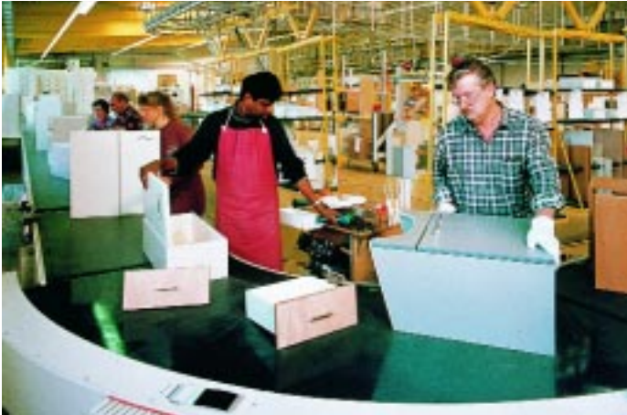
Die DV-gestützte Ablauffertigung ermöglicht es Sanipa, modifizierte Kundenwünsche noch bis zu zwei Wochen vor Produktauslieferung zu berücksichtigen
