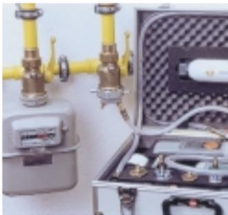
*Der Analyse-Profi-Koffer enthält das elektronische Druckmeßgerät Testo 312 sowie einen Rechenschieber zur Leckmengenbestimmung*
