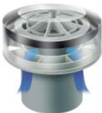
Das Durgo-Ventil öffnet sich nur bei Unterdruck. Ansonsten ist es absolut dicht
