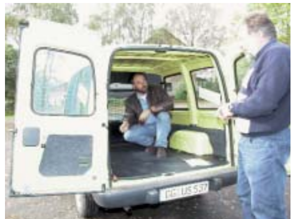
Beim Rüsselsheimer Lastesel ist die Ladekante zu hoch, die Seitentür fehlt ebenso wie eine ausreichende Ladebeleuchtung und die Übersicht nach hinten ist trotz Fenster schlecht
