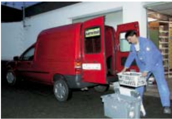
Dem Kölner fehlt eine seitliche Schiebetür und die Ladungssicherung im großen Kasten mit niedriger Ladekante
