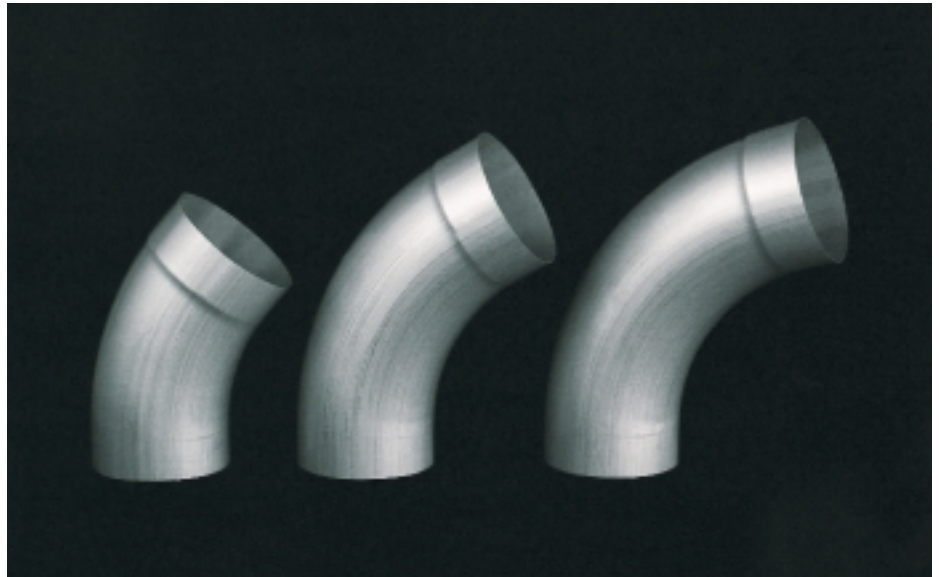
Dank einer 35 mm tiefen Rohraufweitung fügt sich der Objektbogen ohne Lötarbeiten nahtlos in den Regenfallrohrstrang ein
