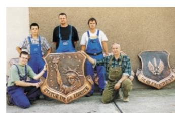
viermal ausgeglüht und auf Blei getrieben werden, bis es nach dem Abbeizen gefärbt (Schwefelleber) und lackiert werden konnte. Anschließend wurde ein 5 cm breiter Rand angearbeitet, der zur Wandbefestigung benötigt wurde.
