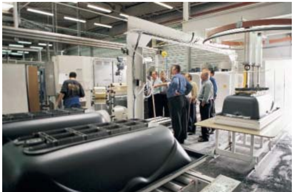
Die speziell entwickelten und patentierten Toplax Vollkunststoff-Schalen basieren auf einem Verbundwerkstoff aus Acryl und ABS
