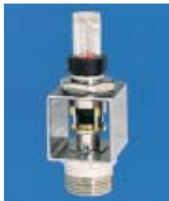
Schauglas. Die durchfließende Wassermenge wird über einen Schwimmer mit Gegenfeder am Sichtglas angezeigt.
