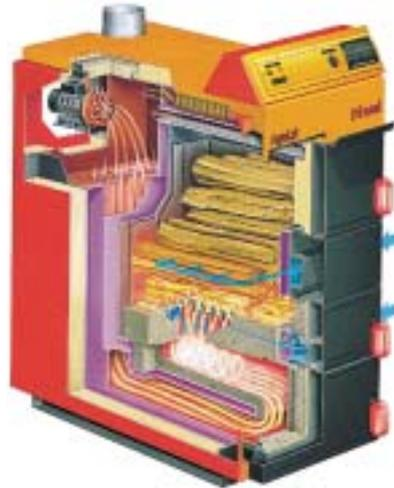
Die Holzvergaser-Technologie soll eine saubere und sparsame 3-Stufen-Verbrennung und einen Wirkungsgrad von über 90 % ermöglichen. Auf Wunsch ist der Agrolyt auch mit einer Lambda-Sonde erhältlich. Mit der Verbrennungsregelung Top Tronic lassen sich nach Herstellerangaben Abgasqualität, Wirkungsgrad und Bedienungskomfort weiter optimieren.
