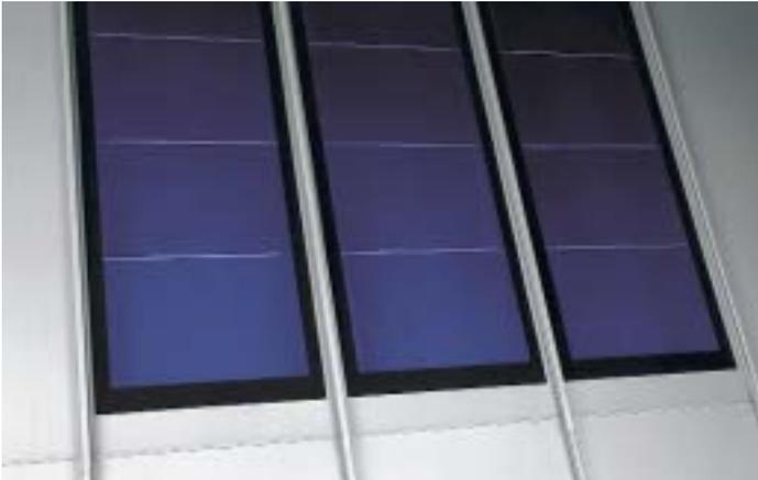
ohne zusätzliche Befestigungselemente auf allen Dächern zwischen 10° und 75° Neigung verlegt werden. Die einzelnen Dachelemente werden mit nur zwei elektrischen Steckverbindungen miteinander verschaltet. Der Anschluß der Photovoltaikanlage an den Wechselrichter erfolgt über den Elektroinstallateur.
