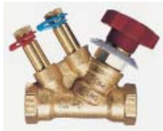
hydraulischen Abgleich ermöglichen. Es verfügt über integrierte Meßnippel, die nicht nur die fachmännische Einregulierung, sondern auch die Diagnose und Dokumentation von Störungen während des Betriebes zulassen sollen.
