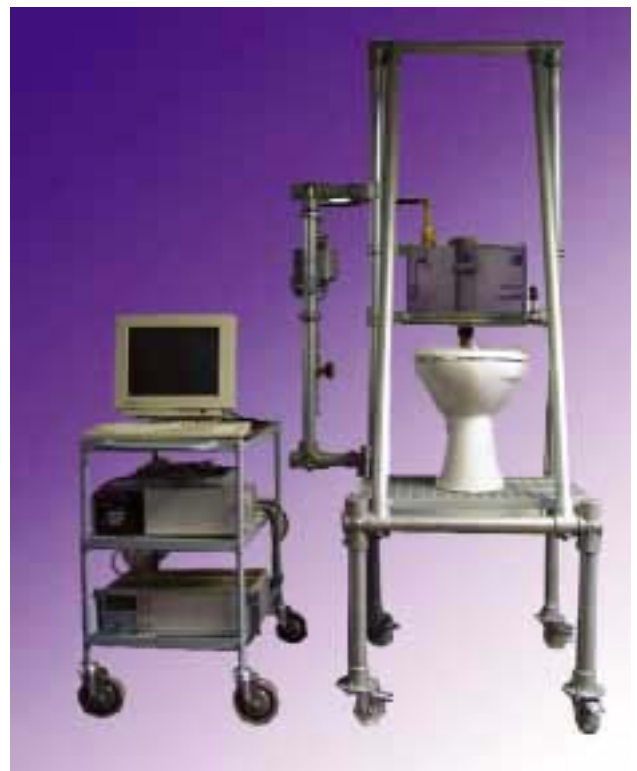
Bild 2 Spüleigenschaften von Klosettbecken wurden auf solch einem Versuchsstand getestet
