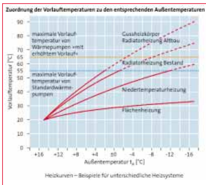
Bild 1 Je nach vorhandenem Heizsystem muß die Wärmepumpe unterschiedlich hohe Vorlauf-Temperaturen bereitstellen. Alternativ können Wärmepumpen „mit erhöhtem Vorlauf“ zum Einsatz kommen
