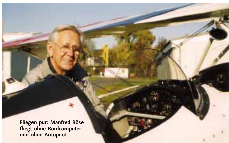
Die Skybolt RE III ist 5,99 m lang, 2,13 m hoch und hat eine maximale Spannweite von 7,32 m
