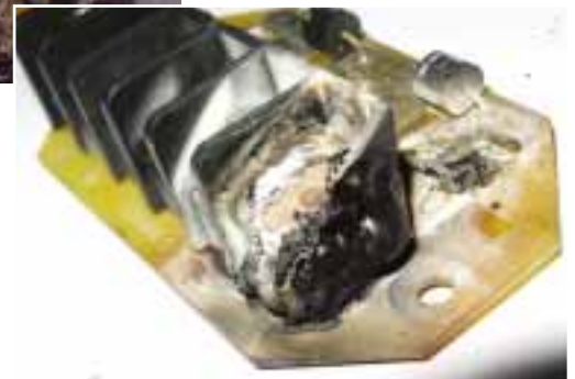
Aussage von Total Energie: In Folge einer fehlerhaften Installation hat die Lötstelle der Klemme versagt und letztlich zum Ausfall des Moduls geführt
