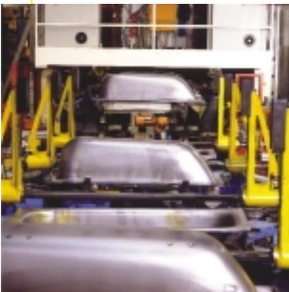
**Auf der Produktionsanlage werden bei Kaldewei fünf Badewannen pro Minute gefertigt**
