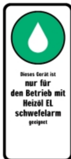
Bild 2 Aufkleber für Leitungsanlage und Brennwertkessel
