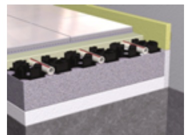
Oberbodenbelag verlegen (z. B. Fliesen)
