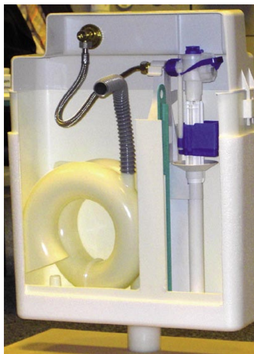
Kern des neuen Mepa-Spülkastens ist der fest mit dem Spülkasten verschweißte Ringsiphon. Da sich alle Dichtungsteile außerhalb des Wassers befinden, hat auch die Wasserqualität keinen Einfluss auf die Dichtigkeit des Spülkastens
