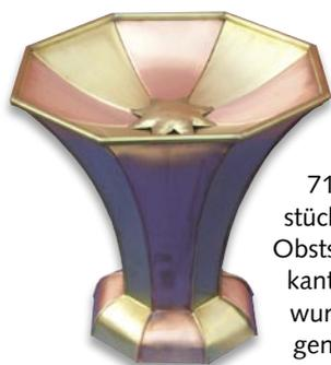
Den Einsatz verschiedener Materialien präsentiert Kai Löffler aus 71384 Weinstadt in seinem Meisterstück. Die Außenteile der achteiligen Obtschale sind nach außen gefalzt, gekantet und gerundet. Zusammengefügt wurden Außen- und Innenteil mittels genutetem Messingrohr. Den Mittelpunkt der Schale bildet ein handgetriebener achteckiger Stern.
