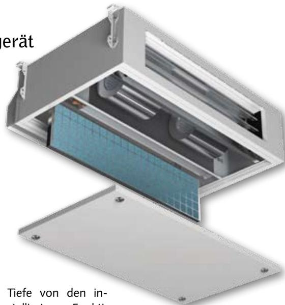
Tiefe von den installierten Funktionsmodulen abhängt und minimal 650 mm beträgt. Die Breite ist abhängig von der Luftleistung und liegt bei 650, 1050 oder 1550 mm. Das Komplettpaket ist bis auf den externen Regler, der im Aufenthaltsbereich zu installieren ist, komplett für einen 230-V-Anschluss verdrahtet.
