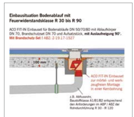
Bild 8 Einbausatz mit Brandschutz-Bodenablauf in 100 mm dicker Decke
