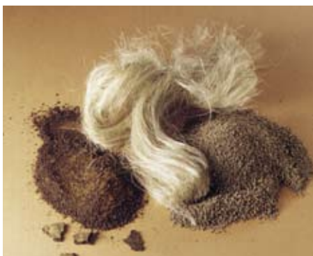
Bild 1 Schmutz- und Rostpartikel sowie Hanfreste stellen ein Problem für Trinkwasserinstallationen dar
