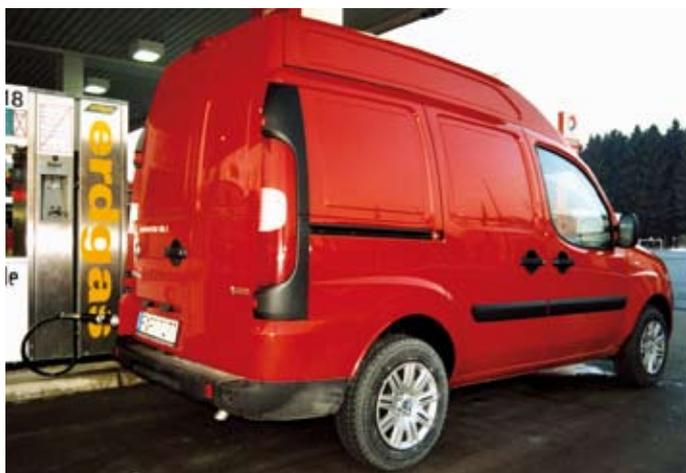
Mit Hochdach erreicht der Doblò Cargo 3,8 m<sup>3</sup> im Frachtraum, Erdgastanks sind platzsparend unter dem Ladeboden angeordnet
