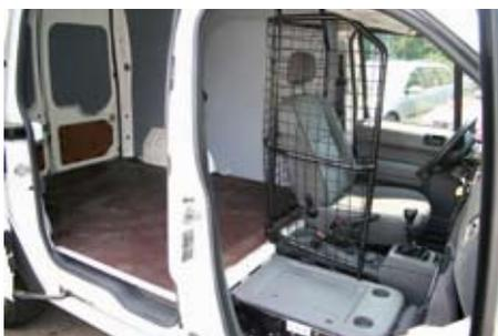
Das Schwenk-Gitter im langen Ford Connect schützt den Fahrer und macht bei abgesenktem Sitz Ladelängen von 2,7 m möglich
