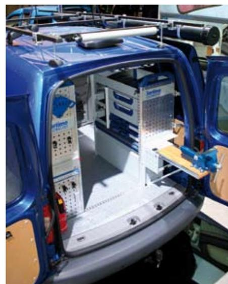
Für den Caddy hat VW das neue Y-Paket geschnürt: Dachträger und Einrichtung ganz aufs SHK-Handwerk zugeschnitten
