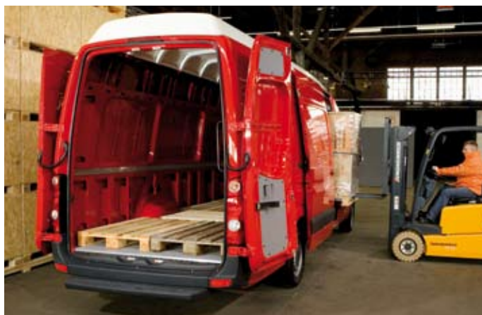
Dank besonderer Einzelbereifung hinten passt beim Crafter / Sprinter mit 4,6 t zGG erstmals eine Palette quer zwischen die Radhäuser
