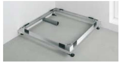
In fünf Arbeitsschritten ist das Einbausystem montiert: Zunächst wird der Einbaurahmen mit den individuell verstellbaren Füßen in der gewünschten Position auf dem Rohbeton aufgestellt und am Boden befestigt
