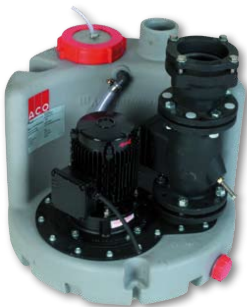
Bild 2 Fäkalienhebeanlagen besitzen einen Sammelbehälter, der zum drucklosen Zwischenspeichern des zulaufenden Abwassers dient
