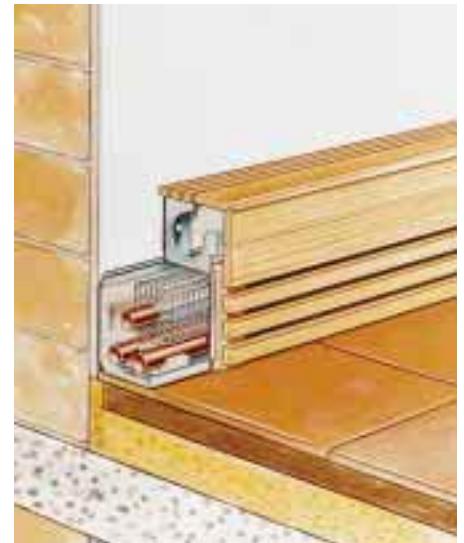
Bild 18 „Paradigma Sockelheizleiste“ mit Holzverkleidung
