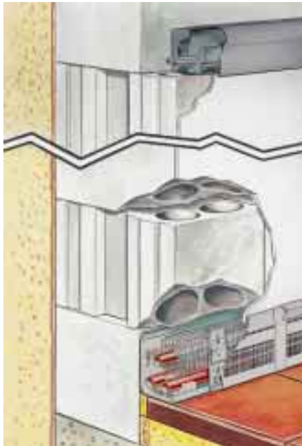
Bild 13 „Aura Wandheizung“ mit „Kalksand-Luftkanalstein“ (Paradigma)
