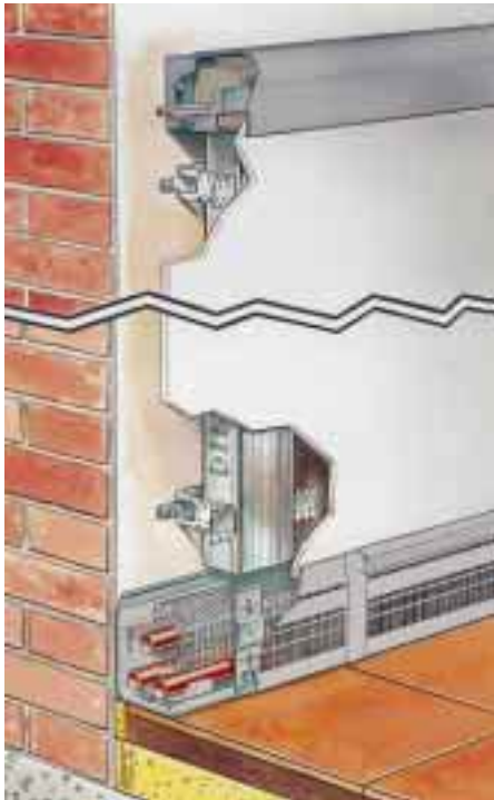
Bild 16 „Aura Wandheizung“ mit „Knauf-Vorsatzschale“ und Kabelkanal (Paradigma)
