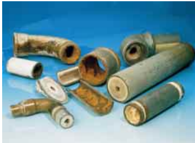
Bild 2 Das Rottenburger Trinkwasser liegt im Kalk-Kohlensäuregleichgewicht. Allerdings begünstigt der Sättigungsindex von +0,29 starke Rohrinkrustation, wie sie dieses Bild zeigt. Korrosionserscheinungen sind hingegen unbekannt
