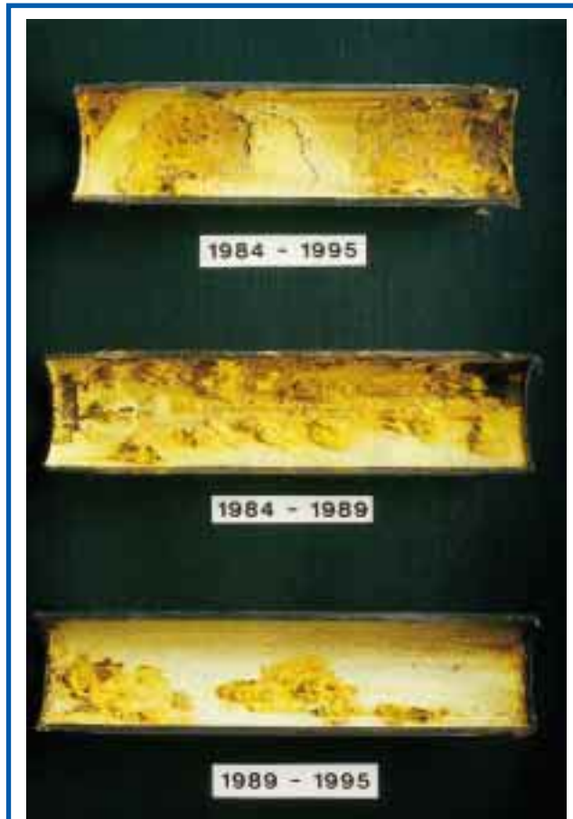
Bild 3 Aus der ehemaligen Zehntscheuer entstand ein Kulturzentrum. Seine nicht durchgängige Nutzung führte zu Wassertrübung und Verschmutzung der Perlatoren. Beim Einbau des physikalischen Wasserbehandlungsgerätes wurde ein Rohrstück aus der Hauptwasserleitung entfernt und zur Kontrolle durch ein neues Stück ersetzt. Mitte: Altrrohr, das die zwischen 1984 und 1989 – vor Beginn der Wasserbehandlung – gewachsene Inkrustation zeigt. unten: Neurohr, das 1989 an seiner Stelle eingebaut und 1995 zu Prüfzwecken entfernt wurde. oben: Ein erst nach sechs Jahren Wasserbehandlung ausgebautes Rohrstück zeigt im Vergleich einen deutlichen Rückgang der Inkrustation
