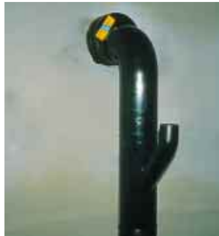
Bild 5 Beruhigter Regenwasserzulauf mit Formstück zur Einspeisung des Trinkwassernachlaufes (freier Auslauf im Gebäude), Material PE
