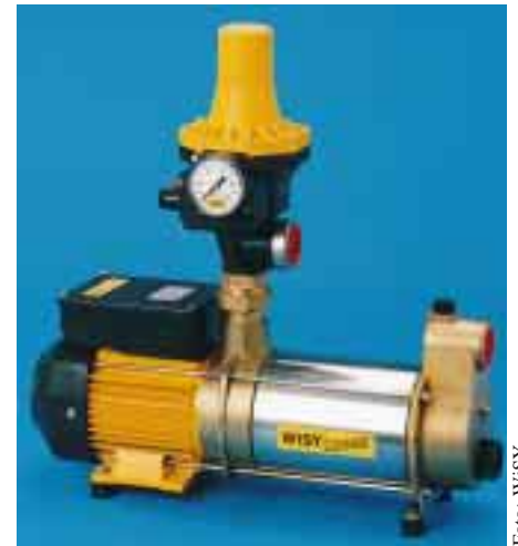
Bild 6 Hauswasserwerk, bestehend aus mehrstufiger liegender Kreiselpumpe mit aufgesetzter wartungsfreier Druckerhöhungs-Automatik
