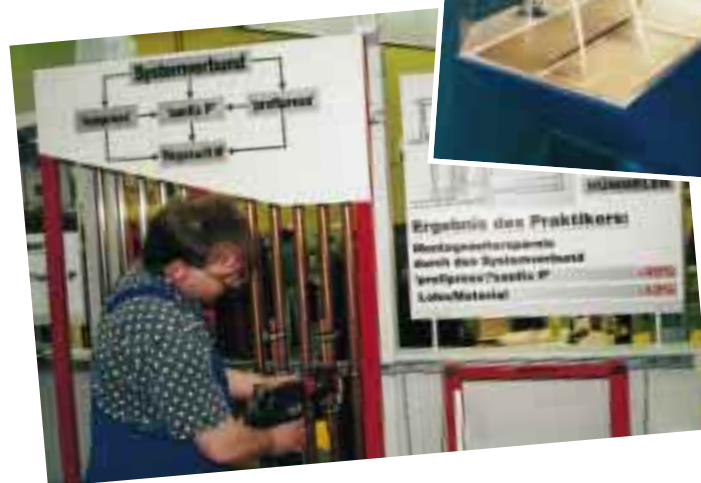
Die Pressverbindung von Kupferrohren, hier bei Viega anschaulich demonstriert, findet immer mehr Freunde
