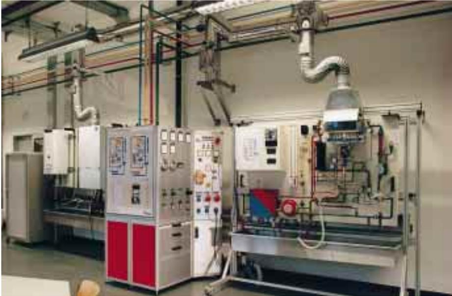
An den Prüfständen können Einstellungen vorgenommen und Abgasmessungen ausgeführt werden
