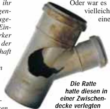
Die Ratte hatte diesen in einer Zwischendecke verlegten Abzweig zernagt
