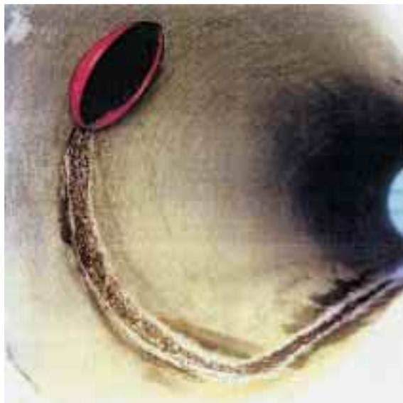
Betonabtrag durch synthetisches Kondensat mit dem pH-Wert 4,0, nach 540 Tagen
