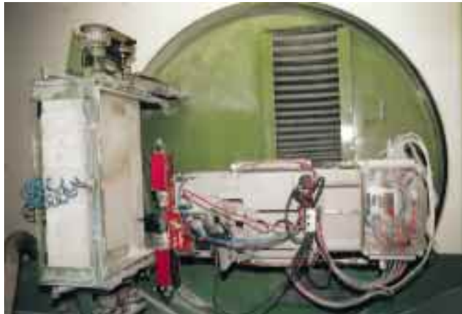
Um ihre Haltbarkeit festzustellen, erfolgt der Maschinentest realitätsnah in verschiedenen Arbeitspositionen
