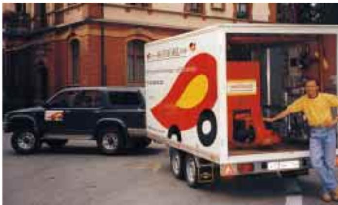
wartungs- oder sanierungsbedingte Stillstandszeiten von normalen Wärmeerzeugungsanlagen überbrückt werden müssen. Sie bestehen aus einer kompletten Kesselanlage mit Weishaupt-Ölbrenner und Schaltschrank, einer Tankanlage mit Ölversorgungsleitung und Auffangwanne, einem Wärmetauscher, einer außentemperaturgeregelten Heizungsarmaturengruppe, einer Warmwasseraufbereitungsanlage sowie Sicherheits- und Expansionsgefäß.
