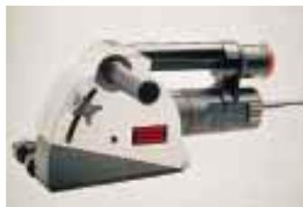
Diese Maschine mit 8,4 kg Ge- wicht ist vor allem zum anfer- tigen großer Schlitz für die Sanitär- und Heizungsinstalla- tion konstruiert. In Mauerwerk werden 230er Diamantscheiben benutzt. Beim Schneiden von Beton beträgt der Scheiben- durchmesser 200 mm.
