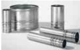
folgt in drei Arbeitsschritten: Kernbohrung, Dichtmasse zwischen den Sicken auftragen, Hülse eintreiben. Dadurch lassen sich Zeit und Kosten sparen. Die Rohrdurchführungshülse ist in den Durchmesser DN 75 bis DN 500 lieferbar. Ein Video stellt das Verfahren vor und kann kostenlos angefordert werden.
