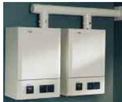
zungsanlagen haben Kaskaden- anlagen ihre Stärken. Die Ab- gasklappe verhindert, daß im Kaskadenüberdruckbetrieb Ab- gas über die nicht in Betrieb be- findlichen Geräte in den Raum ausströmen bzw. im Brenner- bereich Korrosion auftreten kann.
