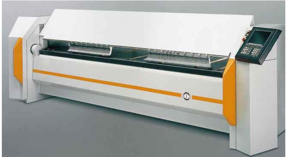
Die Schwenkbiegemaschine Turbobend plus mit gleichzeitig montierten Spitzwerkzeug- (l.) und Geißfußsegmenten (r.)
