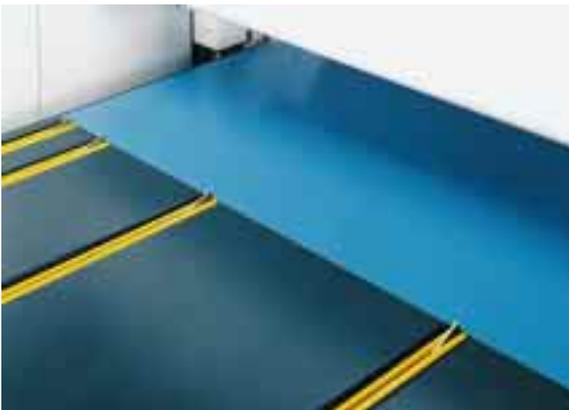
Der Hinteranschlag besteht aus neun automatisch versenk- und verstellbaren „Pop-up-Fingern“
