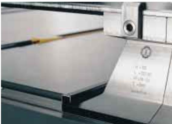
Geißfuß-Endsegmente halten Blechteile, die bereits an einer Seite gebogen sind, sicher in der Maschine
