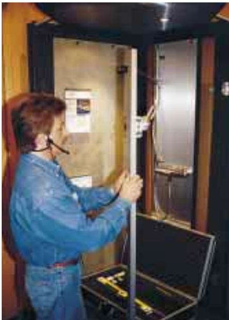
Zweite Neuauflage des Unternehmens ist ein Duschkabinen-Glas-Montageset im 800 x 440 mm großen Alu-Transportkoffer für 620 DM. Zum Inhalt gehören verschiedene Vierkantrohre, Bohrschablonen sowie Einstell- und Ausgleichsschuh für Tür und Seitenwand, Vakuumsauger, Saugheber, Gummimatten, Bleistift, Sechskant-Kugelschraubendreher und Hartmetallbohrer.
