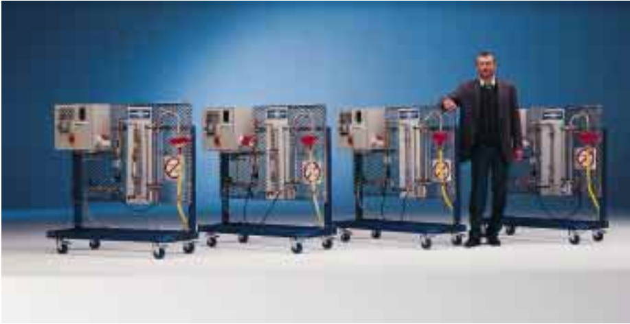
Bild 5 Beispiel für eine Boilerprüfanlage mit der gemäß W 512 die Kalksteinverminderung von Wasserbehandlungsanlagen geprüft werden kann
