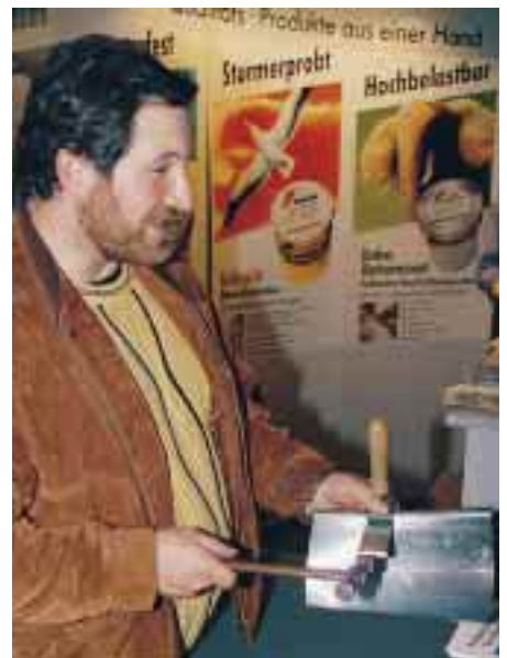
Ein zweiteiliges Werkzeug zum Ausrichten von verbeulten Dachrinnenwülsten war auf dem Stand von Jürgen Egger zu sehen
