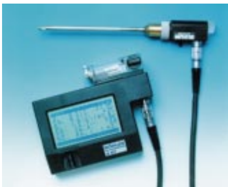
Der handliche Analysencomputer „A 97“ von Wöhler bietet u. a. ein großes Grafik-Display mit Touch-Screen
