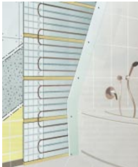
Das einbaufertige „siccus wall“ – Wandheiz-elemente von Velta bestehen aus profilierter PS-Trägerplatte, Heizungsrohr und Alu-Leitlamelle
