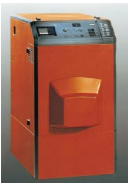
Der Dreizug-Öl-Stahlheizkessel „Menox NAT“ von Unical arbeitet nach dem Flammenumkehrprinzip mit kalter Brennkammer
