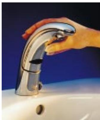
**Dauer-Ein:** Das Wasser fließt permanent bis zu einer Minute lang. Es steht frei, den Wasserfluß durch einfachen Tastendruck auch vor Ablauf einer Minute zu beenden. Andernfalls stoppt er danach automatisch.
