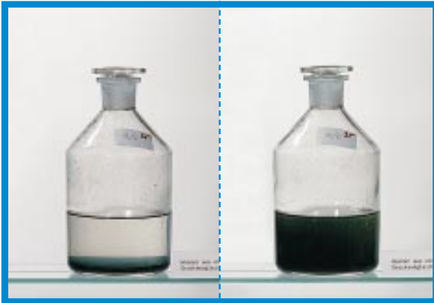
Wasserprobe aus einem nichtdurchströmten MAG: Nach längerer Ruhezeit (l.) und frisch geschüttelt (r.) [6]
