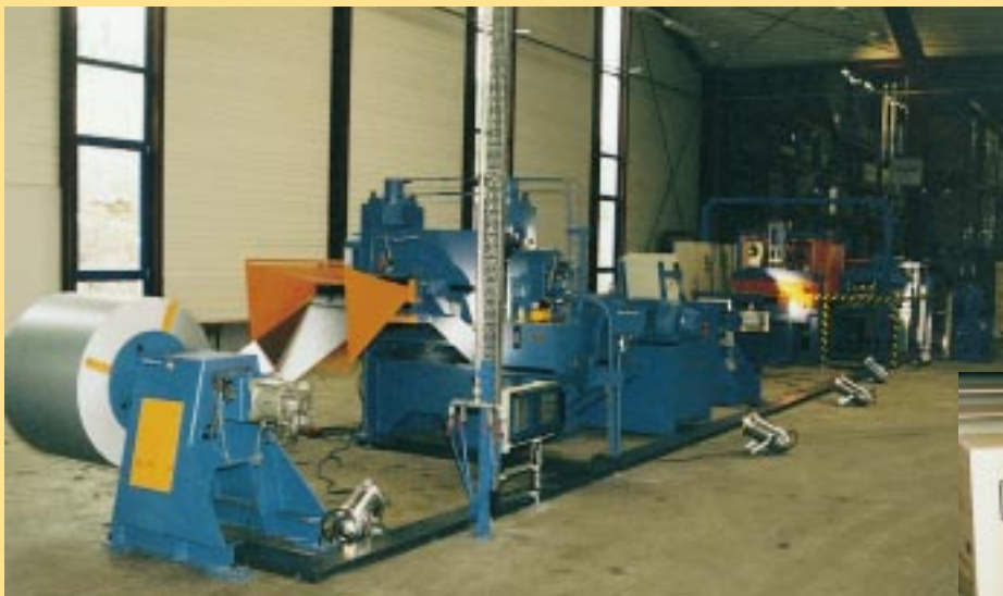
Im Spätsommer erfolgte die Inbetriebnahme der Fertigungsstraße für Dachplatten . . .
