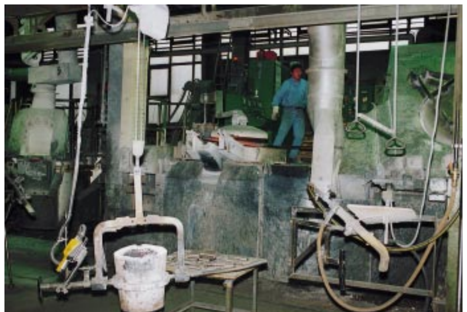
Bevor im Vergießbofen (links) die Formen gegossen werden, erhitzen die beiden großen Schmelzöfen die Rotgußblöcke auf rund 1200 °C
