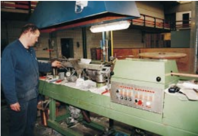
Mit der aufgelöteten Drahtberippung erhält das Kupferrohr eine um den Faktor 20 vergrößerte Oberfläche
