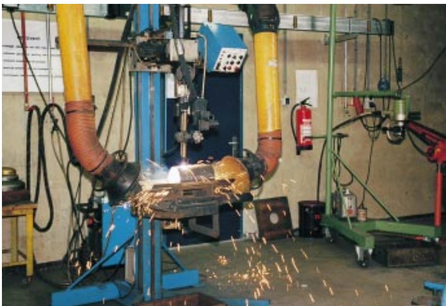
Ab DN 50 sind die Luft- und Schlammabscheider geschweißt
