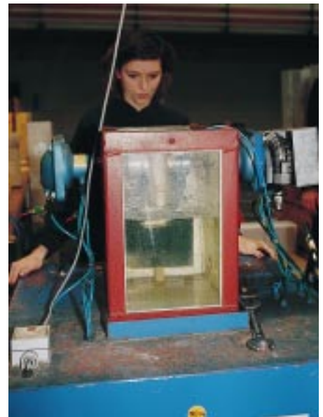
Vor der Auslieferung wird jedes Teil nochmals in die Hand genommen und auf Dichtheit geprüft
