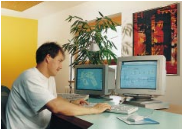
Die Vernetzung aller Systeme der Gebäudetechnik erlaubt eine zentrale Visualisierung aller betriebstechnischen Abläufe mit Überwachung, Bedienung und Dokumentation für ein modernes Gebäudemanagement
