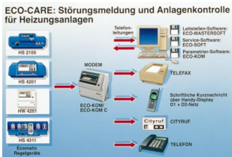
Das Fernüberwachungssystem „Eco-Care“ von Buderus in der Übersicht mit den verschiedenen Meldemöglichkeiten
