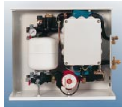
Hydro-Kompaktstation von York zum Einbinden einer Split-Kaltwasser-Außeneinheit in eine Warmwasserheizung
