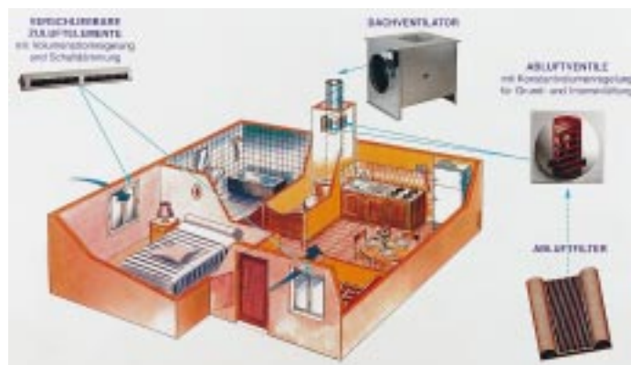
Controvent-System von Aldes mit fensterintegrierten Zuluftelementen zur kontrollierten, energiesparenden Lüftung in Wohngebäuden, Seniorenheimen, Schulen usw.
