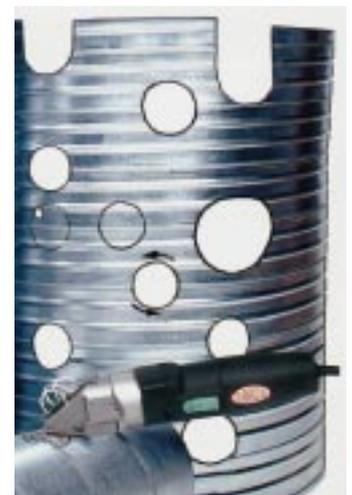
eine Schmitthaltigkeit über 500 bis 1000 m erreichen. Messer und Backen können nachgeschliffen oder durch Ersatzmesser ausgetauscht werden.
