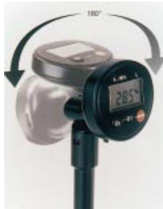
messer des Anzeigekopfes ist nur etwas größer als ein Fünf-Mark-Stück. Ein kurzer Dreh genügt zum Einstellen der Meß- oder Schutzfunktion.
