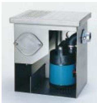
und Schwimmerschalter liegt in einem Gehäuse aus Edelstahl. Ein zusätzlicher Alarmgeber sowie Hand-Automatik-Wahl-schalter und Summer im Steckergehäuse runden das Si-cherheitskonzept ab: Ist das Alarmniveau erreicht, löst eine Edelstahl Elektrode den Start der Pumpe und den akusti-schen Alarm aus. Durch einen elastischen strömungsgünstigen Druckleitungsanschluß wurde die Leistung der Pumpe erhöht. Das Gerät ist universell an-schließbar.
