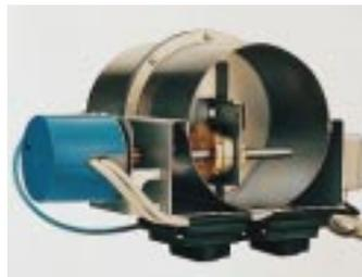
vom Typ ZDM 180 von Kutzner + Weber. Das Gerät kann wahlweise als Zugbegrenzer oder kombinierte Nebenluftvorrichtung eingesetzt werden. Die in einem Edelstahl-Rohr-Gehäuse befindliche Drehklappe wird über fest eingestellte Druckwächter mittels Steuerung per Stellantrieb im Sinne eines Zugreglers bewegt und der Unterdruck auf einen mittleren Wert von 15 Pa begrenzt.
