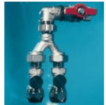
mutter oder ein 1/2"-Anschlußnippel. Ausgangsseitig sind zwei Außengewinde 3/4" mit Eurokonus angeordnet. Das Gabelstück läßt sich auch für andere Verzweigungen – sowohl im Heizungs- als auch im Sanitärbereich – verwenden.
