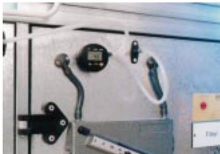
sie sofort an. Das mit einer Magnethalterung versehene Meßgerät paßt in jede Westentasche. Die Nullung ist per Tastendruck jederzeit möglich. Die Anzeige ist umschaltbar von hPa auf mm H<sub>2</sub>O oder mm Hg. Eingesetzt wird Testo 505-P1 bei der Kontrolle des Filterdifferenzdrucks, zum Ermitteln des Feuerraumdruckes, zur Gas-Druck-Messung und zu Über-/Unterdruck-Messungen an Klimaanlage.
