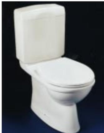
Tiefspülklosetts. Er wurde mit der wassersparenden Zwei-Mengenspültechnik ausgestattet. Diese ermöglicht es, mit fest definierten Spülwassermengen 9 und 3 l oder 6 und 3 l zu spülen und somit sparsam im Verbrauch von Wasser umzugehen. Für die Auslösung des Spülvorganges stehen zwei Tasten zur Auswahl, passend zum Design. Werksseitig ist dieser Spülkasten auf 6 l voreingestellt. Er ist in weiß und den aktuellen Grundfarben lieferbar. Alle Kunststoffteile sind
