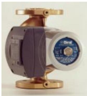
Blueline W 402 und W 403 nach oben erweitert. Bei der neuen Brauchwasserpumpe konnte die Erwärmung des Motors auf ein Minimum reduziert sowie jeglicher Wasseraustausch zwischen Rotorraum und Pumpenteil verhindert werden. Die Pumpen mit Flanschanschluß DN 40 sind sowohl für 3 × 400 V als auch 1 × 230 V einsetzbar und in Grauguß oder Bronze lieferbar. Sie entsprechen bereits der Cenelec-Norm 2003.
